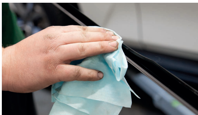
Bild 2: Innenseite des Heckspoilers mit Silikonentferner reinigen
