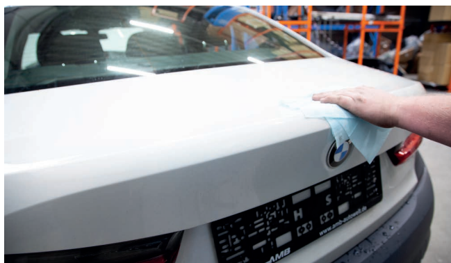
Bild 1: Karosserie mit Silikonentferner reinigen
