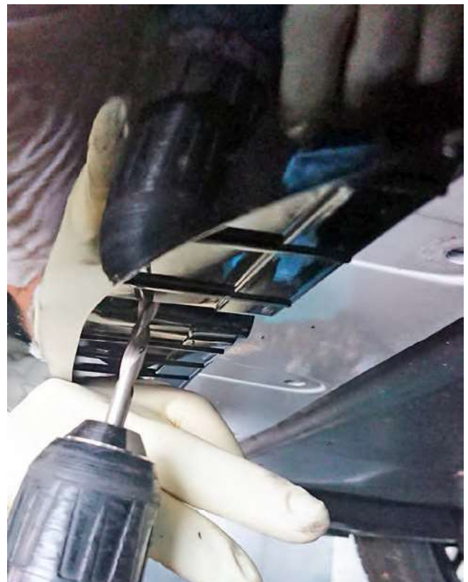
Bild 6: Löcher in die Stoßstange vorbohren
