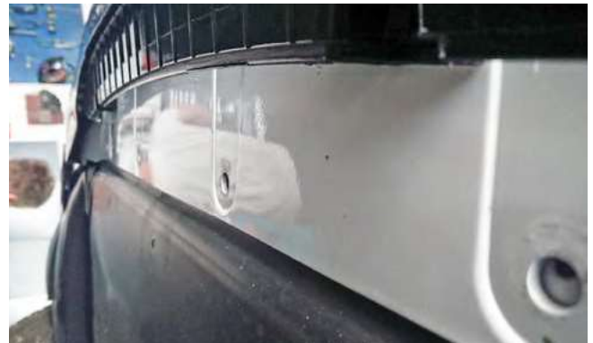
Bild 5: Mittlere Stoßstangenverschraubung lösen
