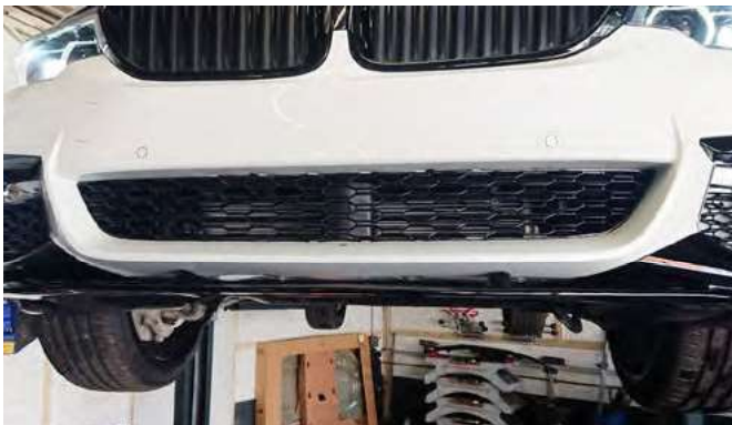
Bild 2: Klebeband abziehen und Frontspoiler fest andrücken
