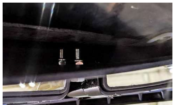
Bild 7: Mitgelieferte Schrauben + Sicherungsmuttern kontern
