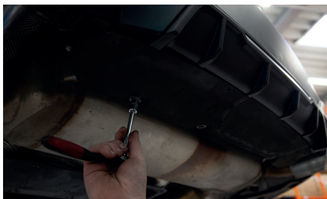
Bild 5: 10er Nuss Schrauben verschrauben
